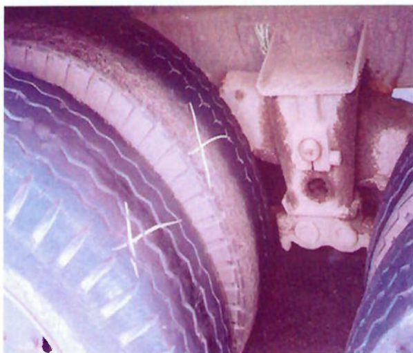
Figura 23 – Estado deteriorado dos pneus (bandas de rodagem irregulares). Fonte: IPEM-SP
